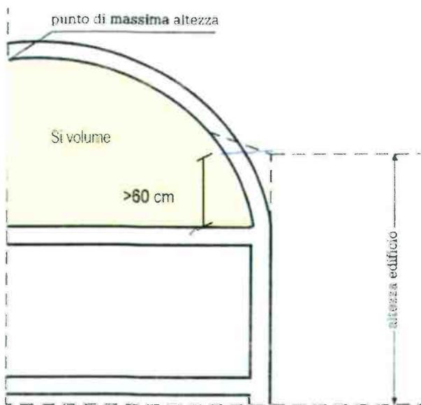
Fig. 19 - Edificio con copertura ad andamento variabile con proiezione della pendenza superiore all'intradosso del solaio dell'ultimo piano abitabile.
